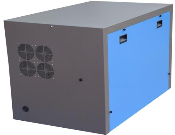
**NOTA:** Se aspira aire frío por la parte inferior y se extrae más cantidad de aire caliente del interior, creando de esta forma una **presión negativa** dentro de la cabina.
